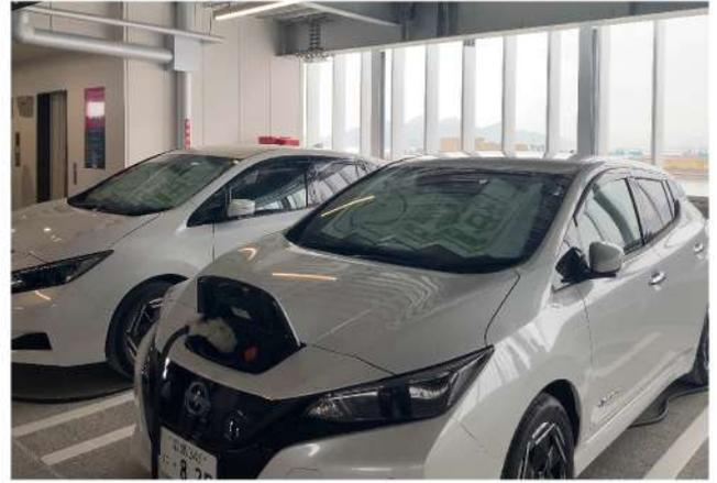
屋上には、パワーコンディショナー含む太陽光パネルを設置しております。太陽光で発電した電気をEV車に蓄電し、災害により停電が発生した際には、EV車から建物側に供給することで、施設内で電気の使用が可能になります。また、EV車に蓄電した電力は携帯電話やその他電子機器を最大100台同時に充電することができます。
