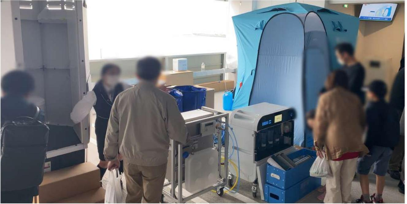
災害時にライフラインの断絶に備え、下水道接続なしでどこでも設置が可能な紙製トイレを備えております。給排水などの設備いらずで丸ごと可燃ゴミとして処分ができます。また、水を98%再生利用し災害時など水が無い場所でも使用可能なシャワーも備えております。
