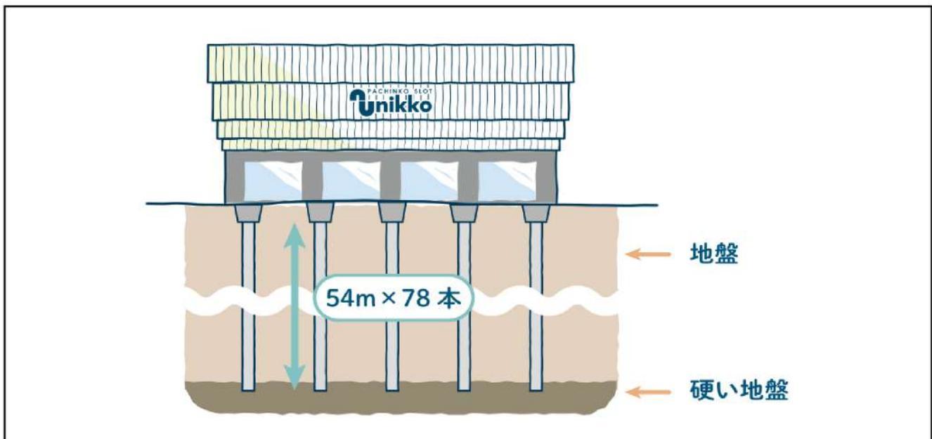
建物は地表から深さ56mにある堅い地盤にしっかりと支持されています。そのために長さ54mのコンクリート製杭を78本も打ち込んでいます。地震や液状化に強い安全な建物をつくり、非常時に一時避難場所及び緊急退避施設としてご利用いただけます。
